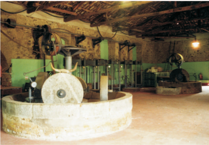
Fig. 14 - Oleificio Bevilacqua (Curinga, CZ): veduta interna dei locali di lavorazione, con due frantoi a 4 macine, e la batteria delle presse, in numero di sei, sullo sfondo.
