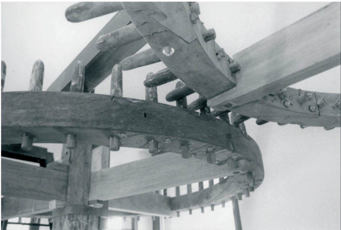
Fig. 17 - Dettaglio delle ruote dentate dei meccanismi di trasmissione del moto dall'albero centrale agli assi verticali dei due frantoi mostrati in figura 16.
